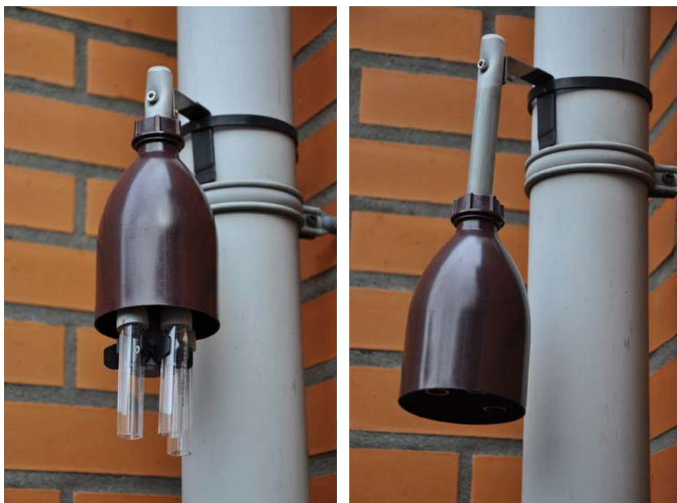
Figuur 1 Monsterhouder met Palmesbuisjes aan regenpijp
